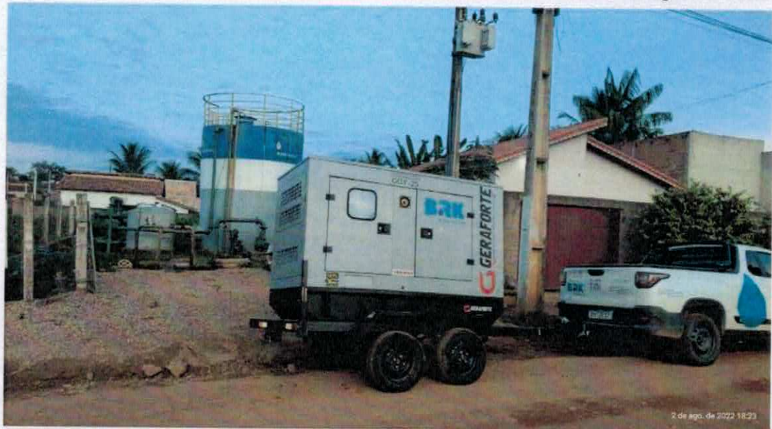
Figura 10 – Grupo gerador para atendimento do sistema de abastecimento de água de Tucumã
